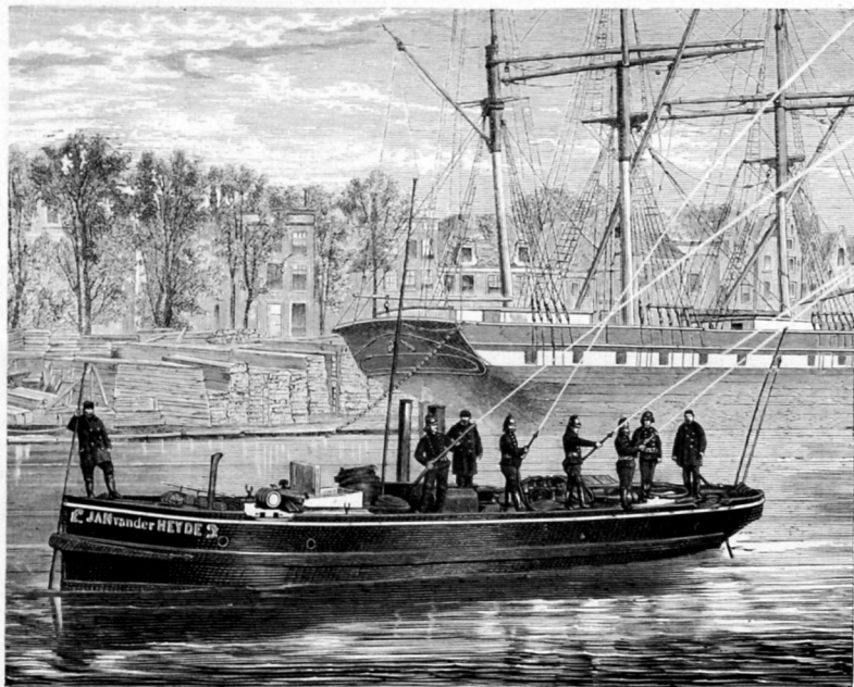
Fig. 2. „Van der Heyde“, Schiffsdampfspritze der Amsterdamer Brandweer. (Aus dem Werke „Das Feuerlöschwesen in allen seinen Theilen etc.“ von G. D. Magirus in Ulm.)
