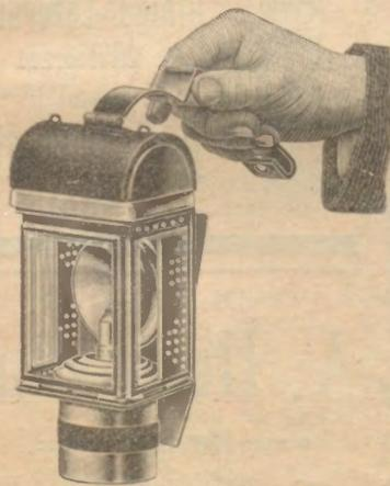
An der Rückwand der Laterne befindet sich der Wasserbehälter, welcher hinten oben eine Füllschraube mit kleiner Luftöffnung hat. Durch das Ausflußröhrchen tropft das Wasser in einen siebartigen Cylinders auf den Boden des Carbidgehältes, wodurch nur soviel Gas entwickelt wird, als gerade nöthig
