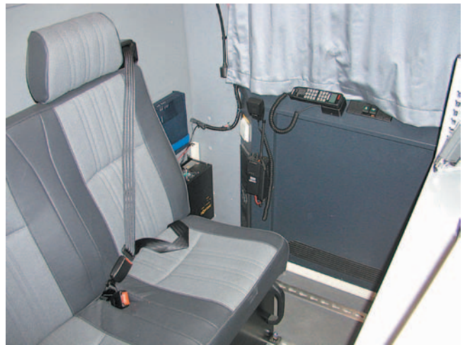
Abb. 2: Zusätzliches 2m-FuG in aktiver Ladehalterung, daneben FMS-fähige Zweitbesprechung des 4m-Bandes, an der Trennwand das GSM-Modul sowie der 230 V-Wandler. (Foto: Bildstelle der Feuerwehr Düsseldorf)
