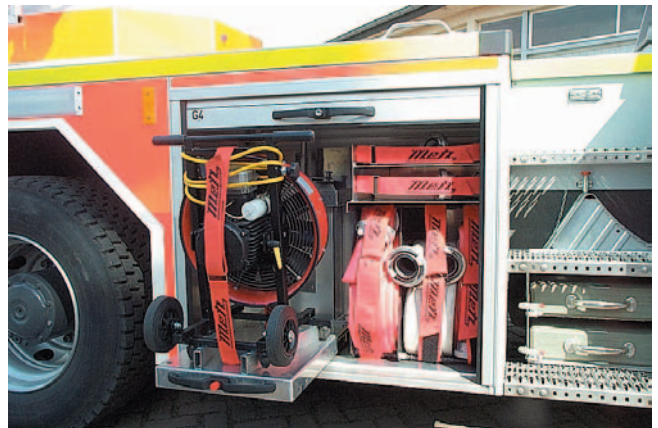
Abb. 6: Elektrolüfter auf Auszug
