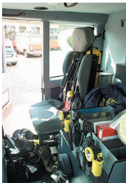
Abb. 9: PA-Sitz des Fahrzeugführers (Bostrom-Sitz)
