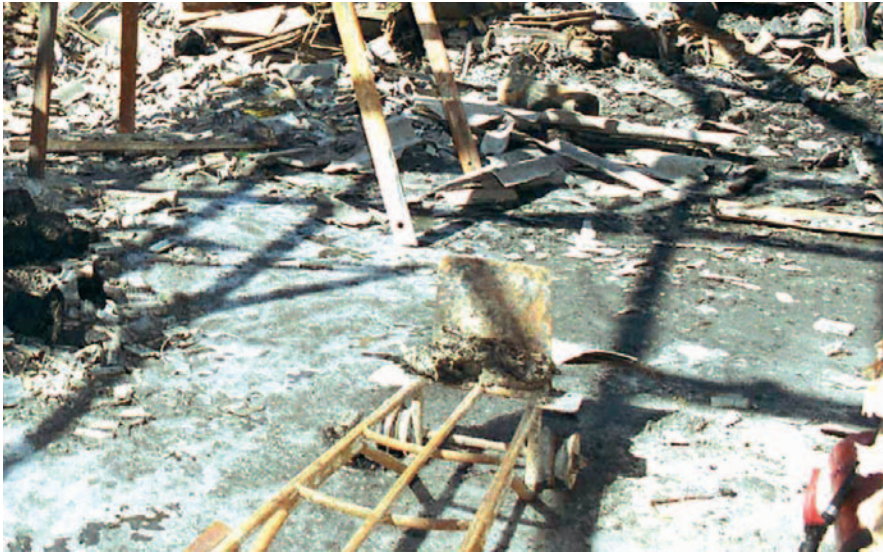
Abb. 2: Rostige Sackkarre nach Brandeinwirkung (Foto: Verfasser)
