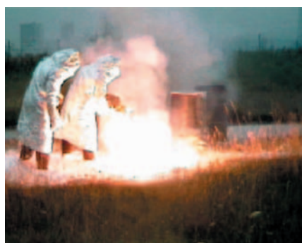
Abb.1: Bekämpfung eines Magnesiumbrandes mit Löschsatz [1]
