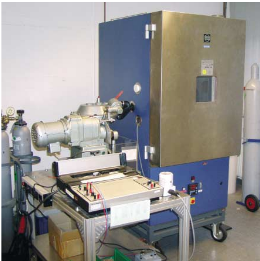
Bild 1: Prüfung auf Temperaturbeständigkeit in einem Temperaturschrank.
