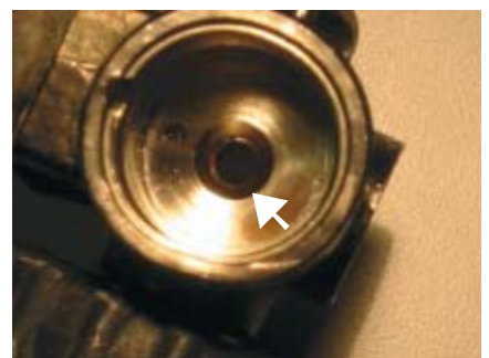
Bild 4: Ablagerungen des thermisch belasteten O-Rings im Arbeitsbereich des Steuerkolbens.
