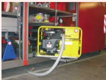
Positives Beispiel für den Betrieb eines Stromerzeugers.
