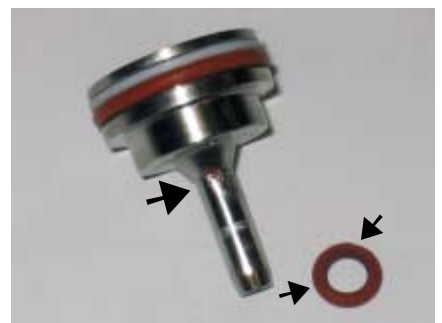
Bild 6: Ablagerungen des thermisch belasteten O-Rings an der Kolbenstange sowie die direkten Beschädigungen an diesem Bauteil des Druckminderers.
