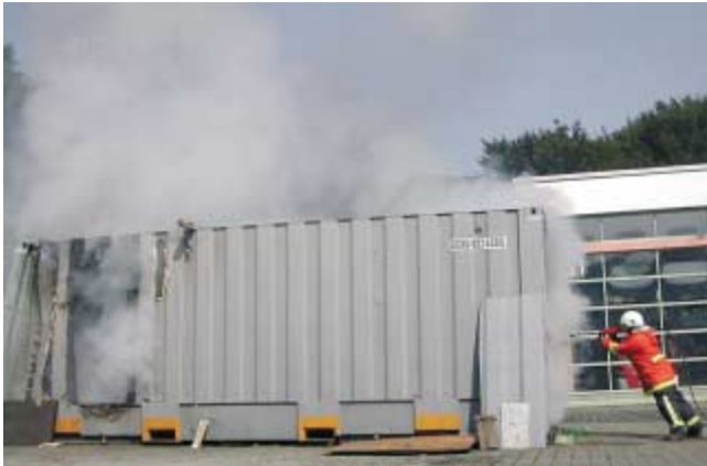
Löschwirkung nach 40 s Wasserabgabe
