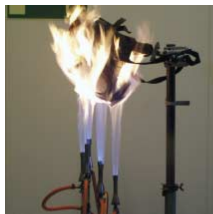
Bild 4: Prüfung einer Vollmaske auf Entflammbarkeit.
