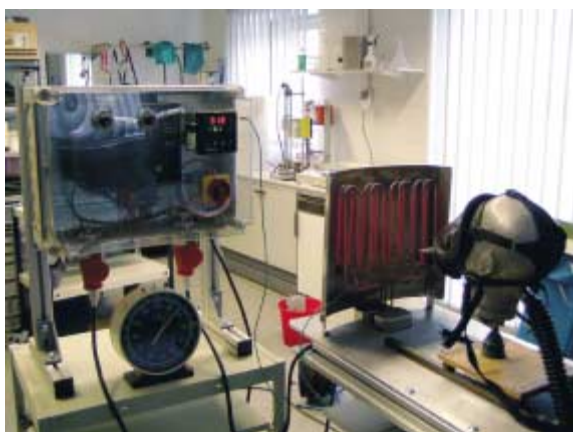
Bild 3: Prüfung einer Vollmaske auf Beständigkeit gegen Wärmestrahlung.
