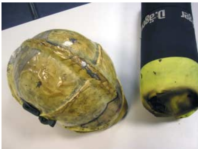
Bild 1: Thermische Schäden am Helm des Truppführers und an der Schutzhülle der CFK-Flasche des verunfallten Truppmannes.
