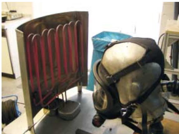
Bild 2: Prüfung eines Lungenautomaten auf Beständigkeit gegen Wärmestrahlung.
