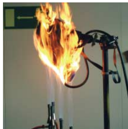
Bild 5: Prüfung eines Lungenautomaten auf Entflammbarkeit.
