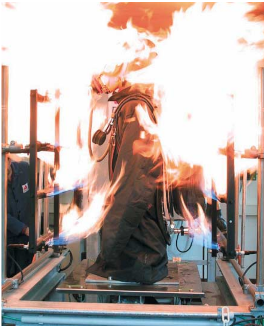
Bild 6: Prüfung der Beflammung nach prEN 137:2002. Foto: Deutsche Montan Technologie GmbH
