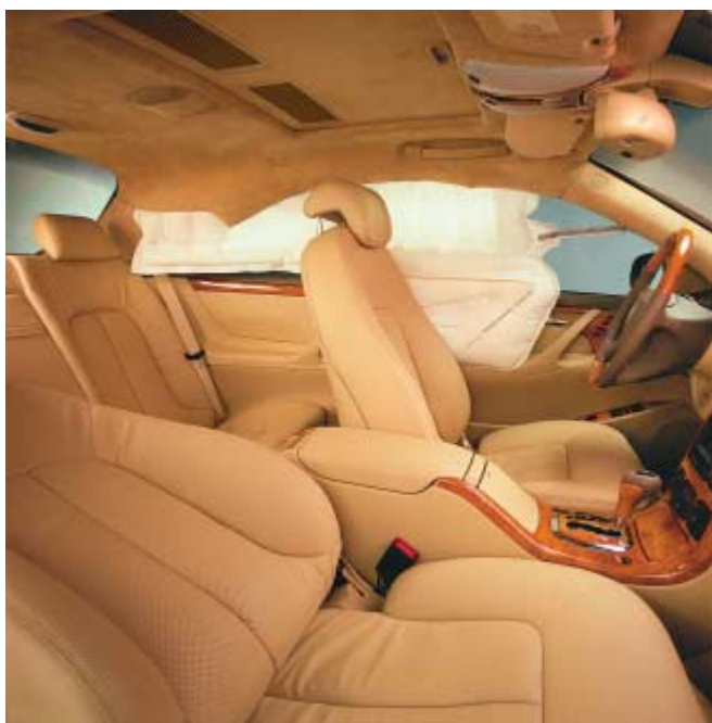
Abbildung 4: Die umfangreiche Airbagausstattung besteht aus mehrstufigen Fahrer- und Beifahrerairbags, Seitenairbags in den Türen und Kopfairbags. Foto: Mercedes-Benz
