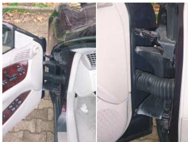
Abbildung 3: Das Türscharnier hat eine komplexe Konstruktion, da die Tür vor dem Öffnen erst einige Zentimeter nach vorne schiebt.
