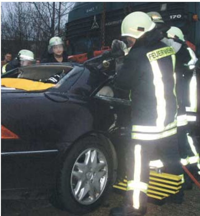
Abbildung 12: Die C-Säule wird im obersten Bereich durchtrennt, um den Hybrid-Gasgenerator zu umgehen.
