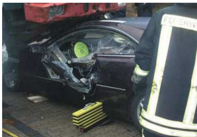
Abbildung 10: Das Bild zeigt die Tür während der Türentfernung. Ständiges Nachgeben des Materials gestaltete das Entfernen sehr schwierig.
