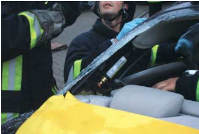
Abbildung 11: Mit einem kleinen Nagelisen wird die Innenverkleidung entfernt und der Gasgenerator freigelegt.
