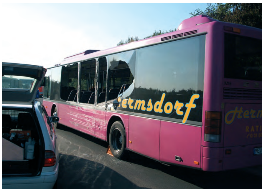
Bei der Kollision ist der Linienbus auf der linken Seite erheblich beschädigt worden. Teile der großflächigen Scheiben sind zerstört, das Glas ist nach innen und außen gesplittert.
