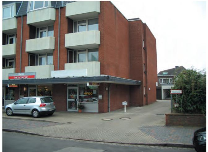
Bild 4: Darstellung einer für die öffentliche Verkehrsfläche amtlich nicht korrekt beschilderten Feuerwehrezufahrt – kein Halteverbot nach StVO
