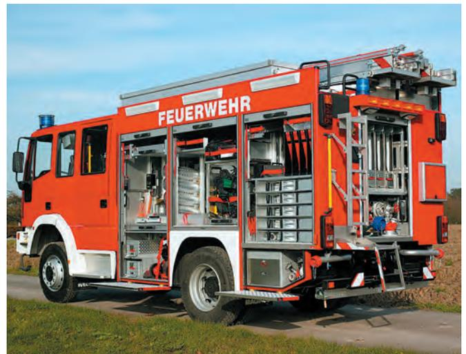
Eine kleine Gruppe des Arbeitskreises „Technik NRW“ (AGBF/LFV) hat es sich deshalb zur Aufgabe gemacht, ein Nachfolgemodell auf der Basis des genormten Löschfahrzeuges LF 20/16 nach DIN 14530, Teil 11, zu entwickeln. Ziel war es, durch Einschränkung der Norm einen einheitlichen technischen Einsatzwert zu definieren, der geeignet ist, folgende Aufgaben erledigen zu können:
