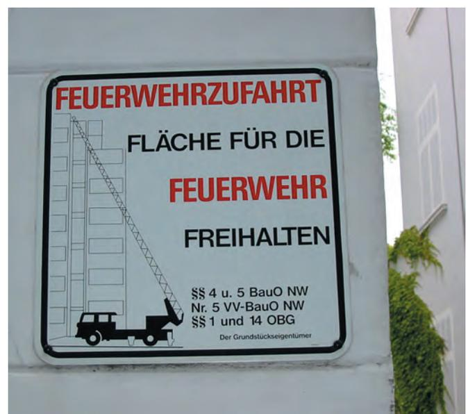
Bild 2: Exemplarische Darstellung einer nach BauO NRW korrekt beschilderten Feuerwehrläche
