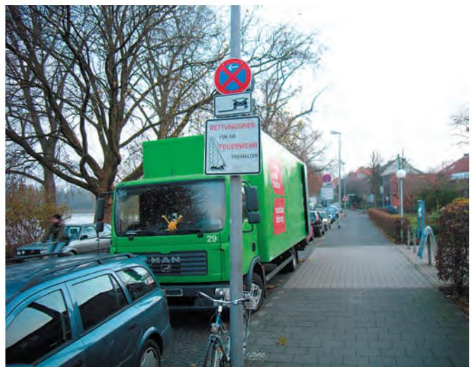
Bild 5: Darstellung einer nicht korrekt beschilderten Feuerwehrezufahrt – Schilderwald (die drei Schilder im Vordergrund befinden sich jeweils auf der Rückseite des vorderen und hinteren Mastes)
