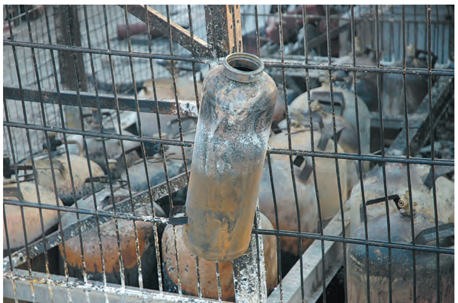
Ein Teil der Gasflaschen war trotz massiver Kühlung nicht zu bergen. Ein Druckgefäßzerknall konnte aber verhindert werden.
