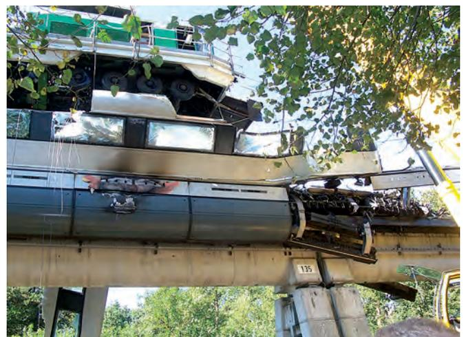
*Deutlich erkennbar: Der Werkstattwagen – hier oben auf dem zerstörten Transrapid – fuhr auf eigenen Rädern und lag damit höher über der Fahrtrasse als der Magnetzug. Deutlich erkennbar auch: Brandspuren am zerstörten Zugteil.*
