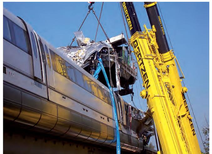
*Der Rettungsschlauch im Zugwagen des Transrapid löste durch den Aufprall automatisch aus. An ihm hangelten sich die beiden Verletzten aus dem Werkstattwagen zu Boden.*
