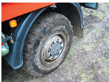
Abb. 2b: Geländebereifung besitzt selbstreinigende Eigenschaften. (Foto: FF Düsseldorf, LG Umweltschutz)
