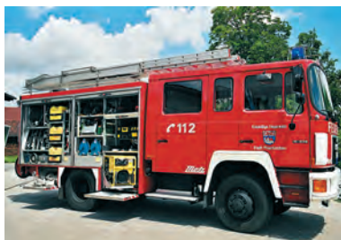
Abb. 4: Auf vielen Allrad-Fahrzeugen der 12/14-Tonnen Klasse werden Reifen der Größe 10 R 22,5 verwendet. Für diese Bereifung gibt es (derzeit?) offensichtlich erhebliche Probleme, überhaupt an „M+S-gekennzeichnete“ Reifen zu kommen.
