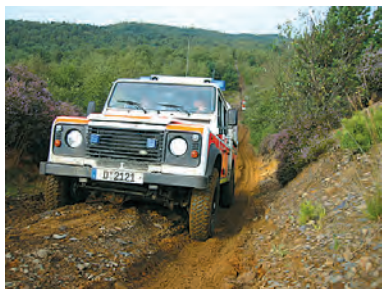
Abb. 1: Geländereifen auf einem „richtigen“ Geländewagen werden für die Traktion im Gelände inklusive ihrer speziellen Eigenschaften (u.a. selbst reinigende Profile) benötigt. (Foto: FF Düsseldorf, LG Umweltschutz)
