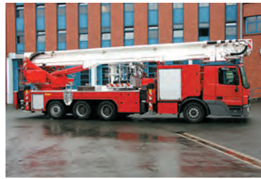
Abb. 5: Reifen an Lenkachsen (hier Vorderachse und Nachlaufachse an einem vierachsigen TM der FW Dortmund!) benötigen ggf. eine andere Profilierung als Traktionsreifen. (Foto: Tampier, Dortmund)
