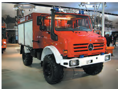
Abb. 2a: Geländebereifung an einem MB U 3000 als hoch geländegängiges TLF 8/18. (Foto: Zawadke, Neu-Ulm)
