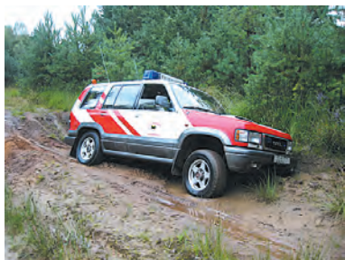
Abb. 3: „Mehrzweckreifen“ sind bei echtem Geländeeinsatz sehr schnell überfordert. (Foto: FF Düsseldorf, LG Umweltschutz)
