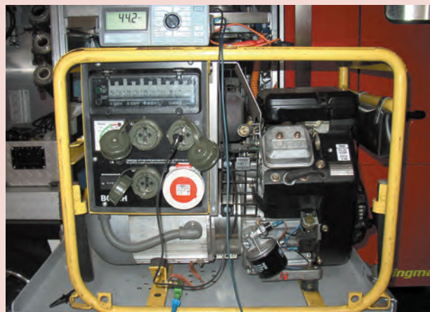
Bild 6: Stromerzeuger in einer Prüfung durch eine Elektrofachkraft (kein Laienmessgerät)
