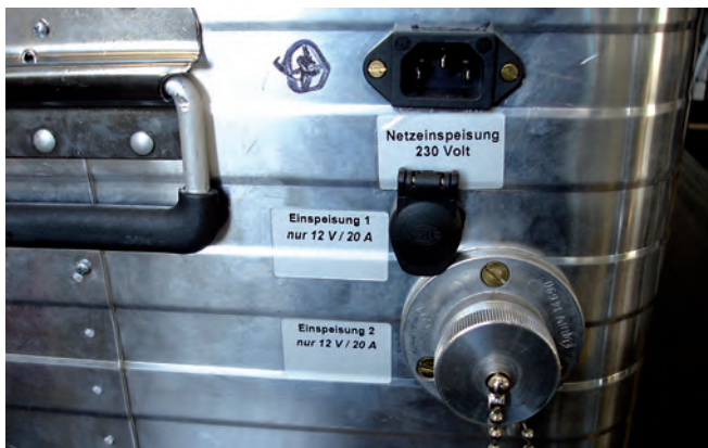
Anschlüsse zur Stromeinspeisung.
