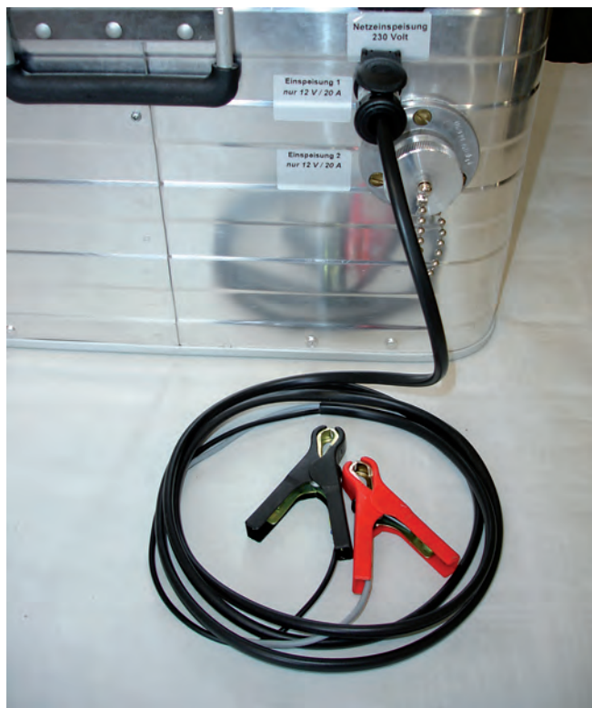
Einspeisung mit 12V-Gleichstrom – hier beispielsweise mit Polklemmen.
