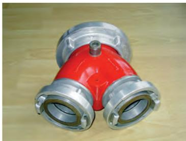
Der aufbauende Unterdruck von der Pumpe wird durch dieses Bauteil vor Erreichen der Schläuche gebrochen und ein Druckausgleich erzielt. Ein Kollabieren der Schläuche ist nicht mehr möglich und eine schnelle Mengenveränderung des Wasserstromes wird dadurch vermieden. Der Vakuumbrecher öffnet bei -0,1 bar und hält einem Druck von 16 bar stand.
