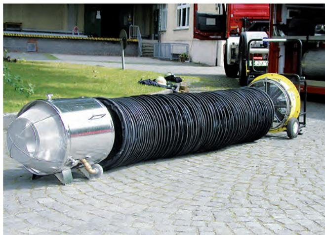
Bild 4: System zur Erzeugung von Mittel- und Leichtschaum.
