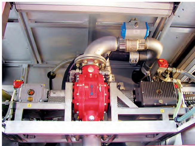
Bild 1: Druckzumischanlage im TLF.
