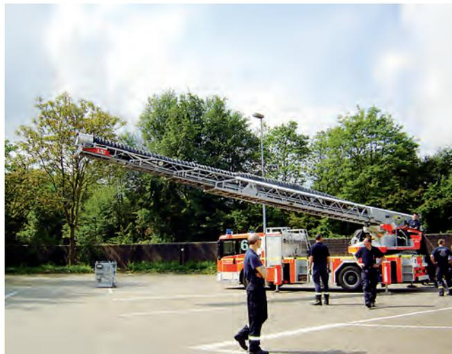
Bild 6: Schaumsystem auf DL als Löscharm.
