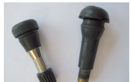
Neues Metallventil und altes Gummiventil im Vergleich.
