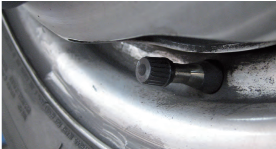
Neues Metallventil in der Felge eines Rettungswagens.
