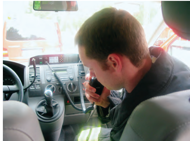
Aufnahme der Digitalfunkausbildung in den Regelbetrieb, hier am Beispiel eines als Übungsleitstelle verwendeten MTF im F III. Im Hintergrund ist die Mehrfachbedieneinrichtung für digitales und analoges Funkgerät und Signalanlage zu erkennen. (Quelle: IdF NRW)
