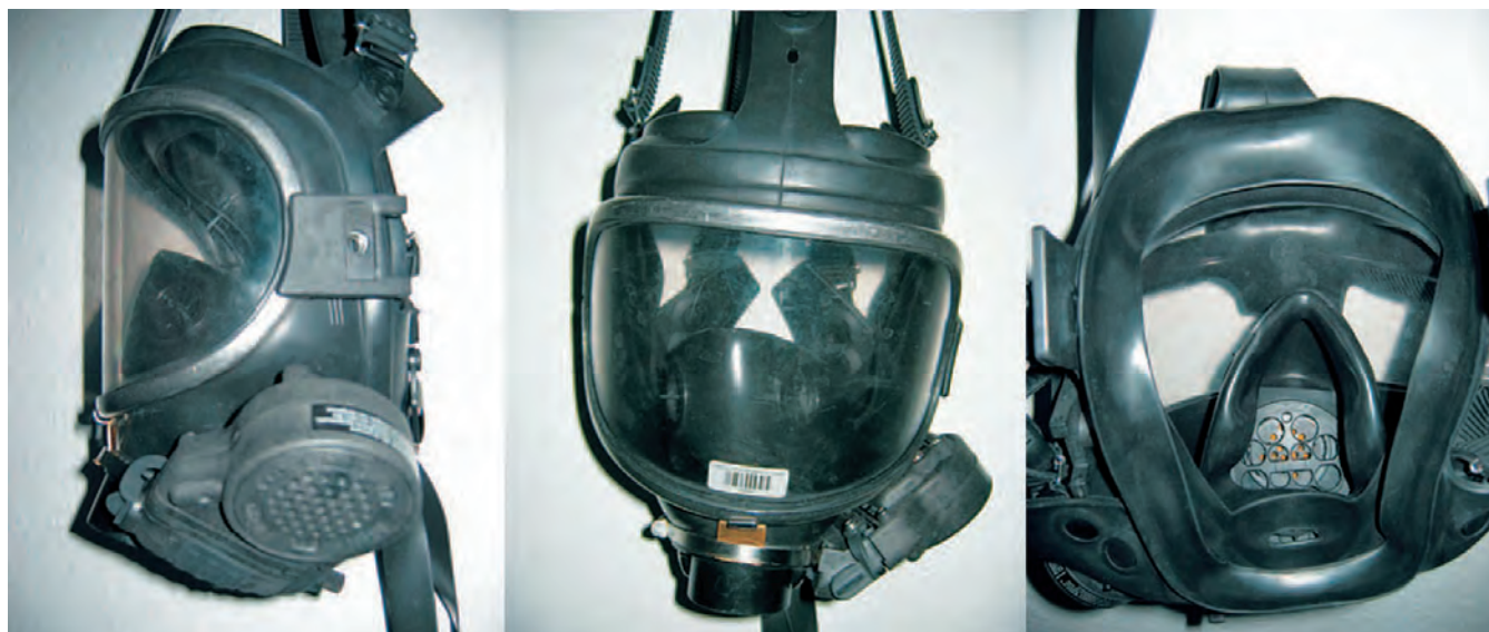
Bilder 1 bis 3: Atemschutzvollmaske mit Voice Amplifier – ein Mikrofon wird anstelle der Sprechmembrane in die Maske eingebracht, Kabeldurchführung nach außen zur Verstärker-Lautsprecher-Kombination.
