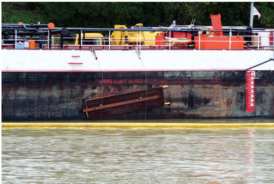
Lecksicherung mit Moosgummimatte, Gewindestangen, Holzabdeckung und Stahlseilverspannung.
