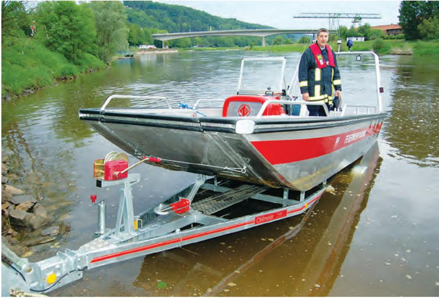
Der Flachbodenrumpf ist für Rettungs- und Hilfeleistungsaktionen im Uferbereich besonders gut geeignet.
