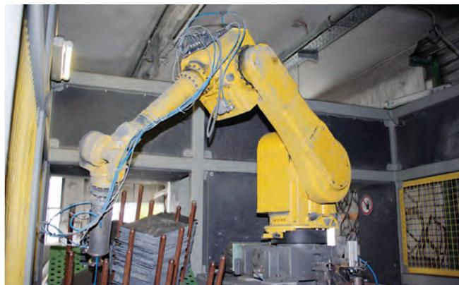
*High-Tec über und unter Tage: Hier ein Roboter zum vollautomatischem Zuschneiden in der Dachschieferproduktion.*
