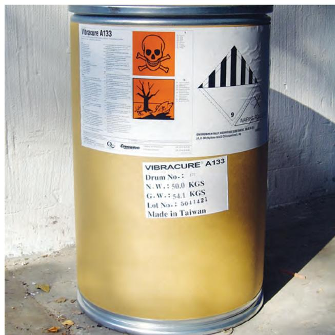
Abbildung 2. Störfallanlage: Auch die Lagerung von mehr als 10 kg dieses Stoffes MOCA führt dazu, dass die erweiterten Pflichten nach der Störfall-Verordnung zu erfüllen sind.
