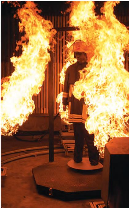
Simulation einer Beflammung.
