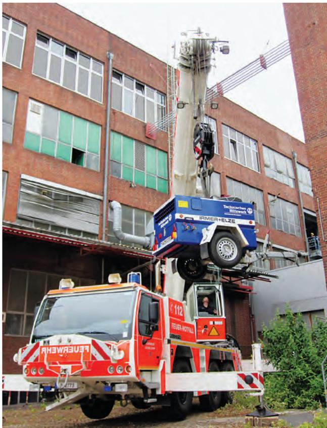
*Gegenseitige Unterstützung: Ein Autokran der Feuerwehr hebt einen mobilen Kompressor des THW in obere Geschosse der Industriehalle.*
