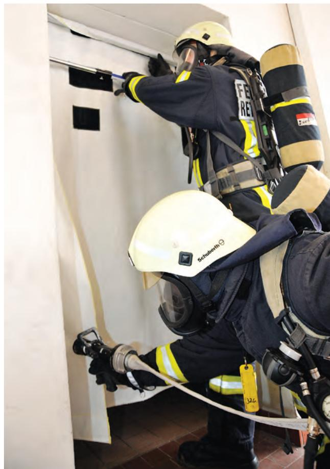
*Der mobile Rauchverschluss kann in weniger als einer Minute im Türrahmen fixiert werden.*
