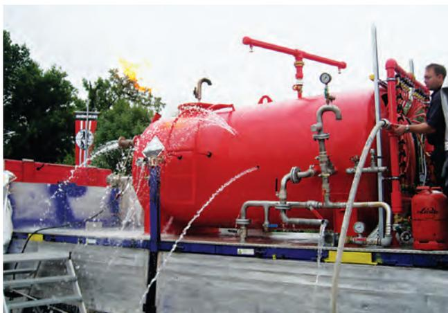
*Gefahrgutübungsanlage des ABC-Zuges Werl mit über 60 Leckagen und Gasbränden.*
