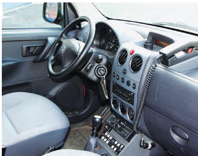
Ausstattung mit 4-fach Blitz, Heckblitzern und 4-m-Funk in der Konsole.
