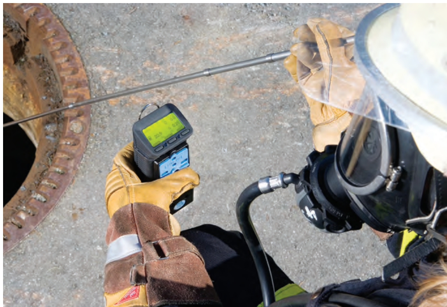
Freimessung in explosionsgefährdeten Bereichen mit dem funktionsgeprüften Microtector II.
