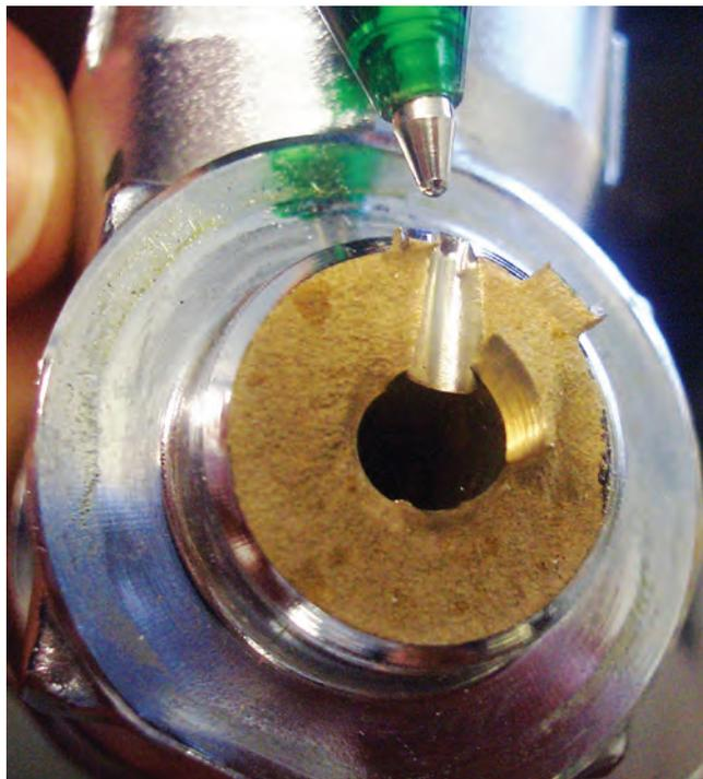
Aufsicht auf das abgerissene Flaschenventil. Die Soll-Bohrung ist deutlich zu erkennen.
