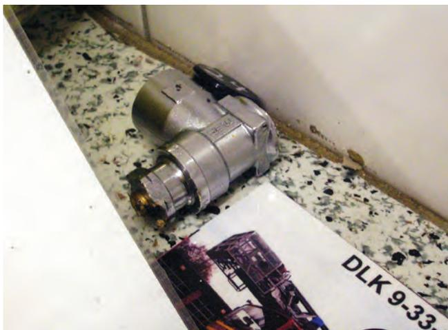
Das abgerissene Flaschenventil. Es wurde auf der Arbeitsfläche gefunden. Einige Bestandteile des Ventils fehlen. Sie lagen verstreut auf dem Boden der Atemschutzwerkstatt.
