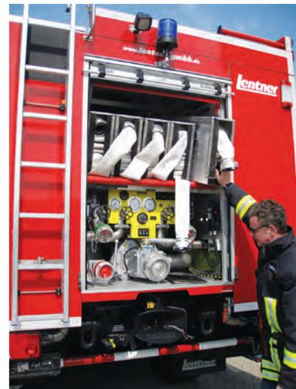
Abnahmebeispiel: Entnahmehöhe – und Sicherheit von Ausrüstungsgegenständen
