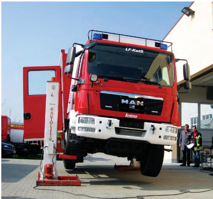
Abnahmebeispiel: Verschränkungsfähigkeit bei Allrad-Fahrzeugen; hier eine Extremdemonstration des Aufbauherstellers
