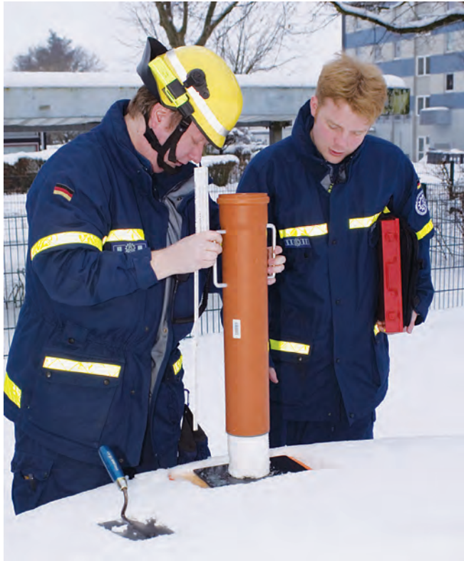
Einfach und effektiv: Der "Gerätesatz Schneelastmessung" besteht aus einem Kunststoffrohr (KG-Rohr) mit Griffen, einer Küchenwaage und einem Zollstock.
