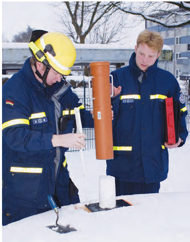
Nachdem das Gewicht bestimmt wurde, misst Baufachberater Jens Kriener (l.) die Höhe des Schneezylinders.
