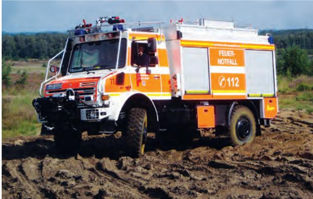
Abb. 3: Für Unimogfahrgestelle und ähnliche voll geländegängige Fahrzeuge gibt es oft gar keine M+S-Reifen, sondern entsprechend ihrer baulichen Ausrichtung auf den Einsatzzweck grob profilierte Geländereifen. Diese Fahrzeuge dürfen trotzdem auch bei Schnee und Eis genutzt werden. (Foto: Cimolino)
