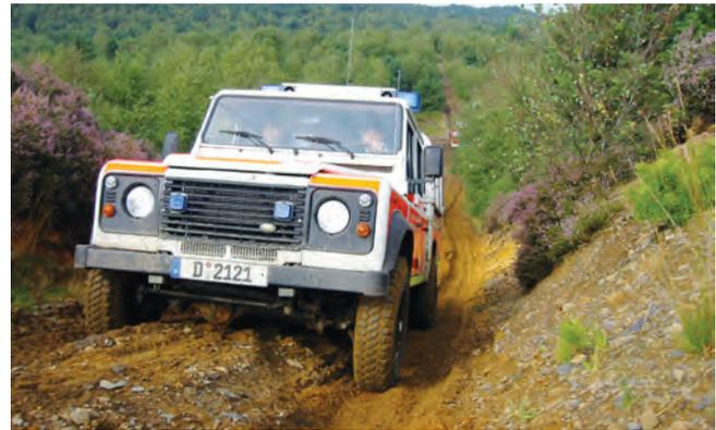
Abb. 5.a: Geländebereifung besitzt selbstreinigende Eigenschaften. (Foto: FF Düsseldorf, LG Umweltschutz)
