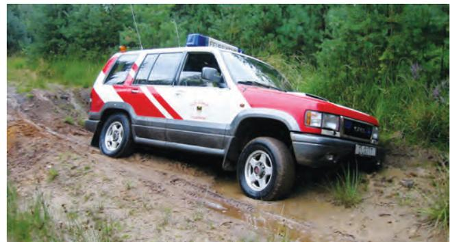
Abb. 5.b: Mehrzweckbereifung kann zwar eine M+S-Kennzeichnung haben, hat aber deutlich schlechtere Traktionseigenschaften im Gelände und v. a. wesentlich schlechtere Selbstreinigungseigenschaften. (Foto: FF Düsseldorf, LG Umweltschutz)
