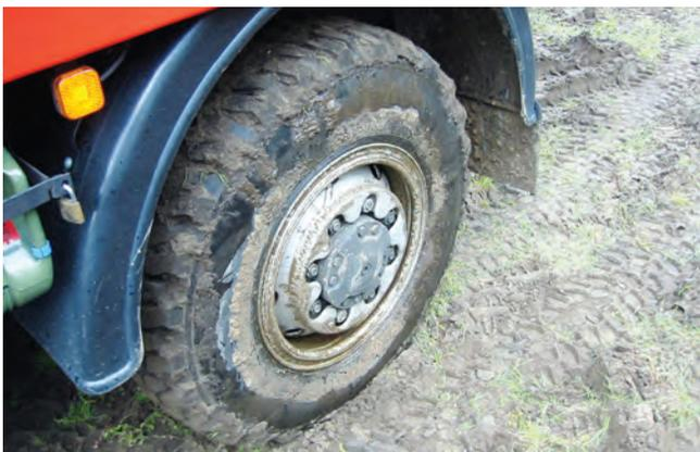
Abb. 6: Geländereifen auf einem "richtigen" Geländewagen werden für die Traktion im Gelände inklusive ihrer speziellen Eigenschaften (u. a. selbst reinigende Profile) benötigt.
