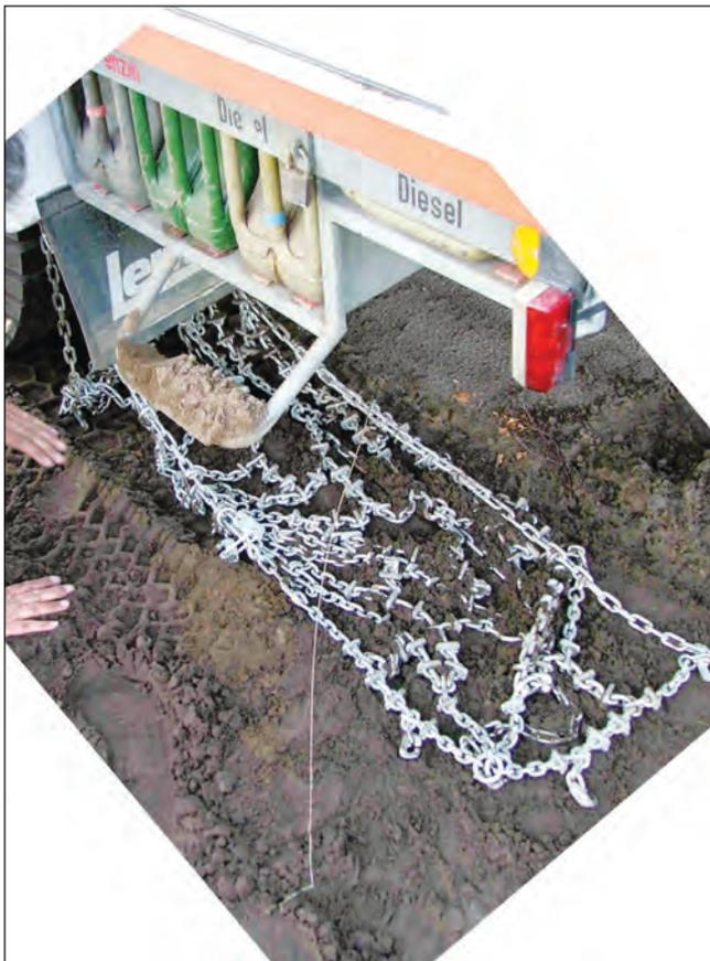
Abb. 8: Stabile Gleitschutzketten können nicht nur auf Schnee, sondern auch in schwerem Gelände eine wertvolle Traktionshilfe sein. Ihre Anwendung muss geübt werden. (Foto: Spikowski, Feuerwehr Düsseldorf)
