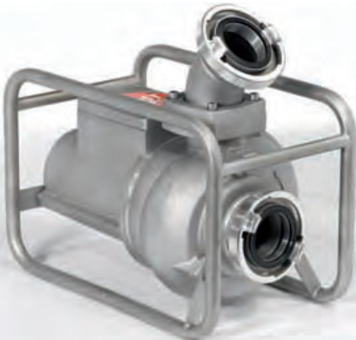
Die Abwassertauchpumpe ATP 10 RL ist trotz robuster Bauweise die leichteste Hochwasserpumpe ihrer Klasse - nicht nur im Verkaufsprospekt, sondern auch auf der Waage. Um im harten Einsatz zuverlässig und sicher arbeiten zu können, ist der Kondensator druckwassergeschützt eingebaut und der Motor vergossen. Flachsaugen ist ohne Zubehör möglich. Auch als Standmodell und in 400 V erhältlich. Auf Wunsch mit aufsteckbarer Kabelhalterung.
