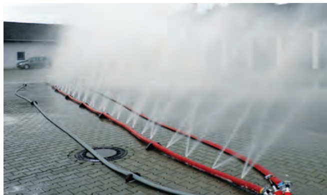
Der Düsenschlauch kann mit Hilfe seiner Standfüße auch schräg ausgerichtet werden – dazu empfohlen 5 Füße.
