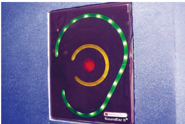
Akustikohr zur Überwachung der Lärmbelastung im Inkubator.
