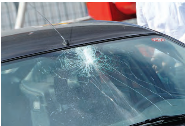
Die Druckgaskartuschen der Rauch- und Wärmeabzugsanlagen beschädigten einen Pkw.
