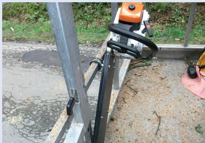
Im Korb der Drehleiter wird eine Motorsäge im Holster transportiert.
